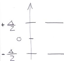
$$Z = \sum_{\alpha} e^{-\beta E_\alpha} = e^{\frac{\beta\hbar\omega}{2}} + e^{-\frac{\beta\hbar\omega}{2}} = 2\cosh\left(\frac{\beta\hbar\omega}{2}\right)$$
